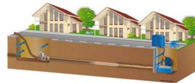
El **sistema de reducción:** Es un sistema de Renovación, en el cual, el diámetro exterior del tramo de tubería de PE se reduce mecánicamente.
