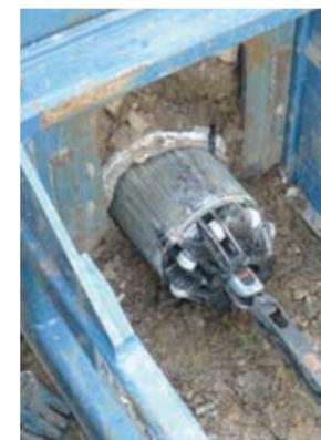
La cabeza de dirección con los rodillos elimina las deformaciones
