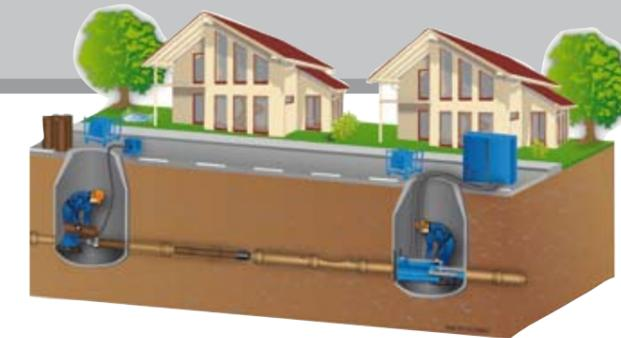
**Renovación con el sistema TIGHT in PIPE (TIP):** En el sistema TIP se utiliza tanto tubería corta como tubería larga para realizar Renovación en tuberías de hormigón y gres. Normalmente se utiliza una tubería nueva de Polipropileno (PP-HM), que va muy ceñida a la tubería vieja (Tight-In-Pipe). El mínimo espacio que queda entre las dos tuberías no tiene que rellenarse.
