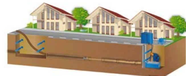
**Calibración-Berstlining:** Los daños parciales en la tubería vieja se ensanchan con el sistema estático GRUNDOBURST o con el sistema dinámico GRUNDOCRACK y al mismo tiempo se introduce la tubería nueva. El espacio libre resultante debería rellenarse.
