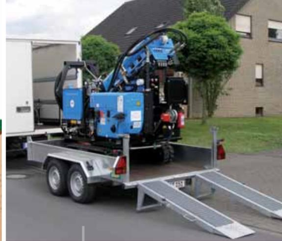
El autopulsado GEODRILL 4R se puede transportar fácilmente en un remolque.
