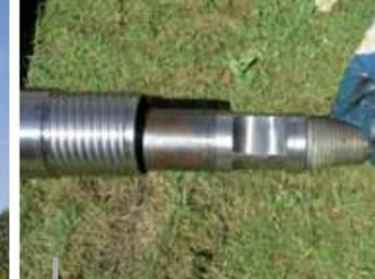
Un tubo de protección con varilla de perforación.
