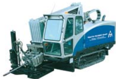
Grundodrill-Sistemas de HDD , Modelos: 15 N + 25 N DN ≤ 500, L < 400 m, fuerza de empuje y tiro 150 kN DN ≤ 600, L < 450 m, fuerza de empuje y tiro 250 kN
