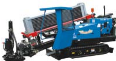
Grundodrill-Sistemas de HDD , Modelos: 10 + 13/15 X TD DN ≤ 350, L < 250 m, fuerza de empuje y tiro 100 kN DN ≤ 450, L < 350 m, fuerza de empuje y tiro 125 kN
