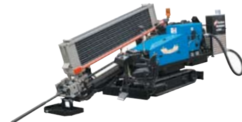
Grundodrill-Sistema de HDD , Modelo: 7 Xplus TD con mezcladora a bordo, ND ≤ 250, 200 m, fuerza de empuje y tiro 100 kN
