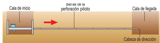
Fase 1: Empuje dirigido de las barras de perforación piloto de 1 m de longitud.
